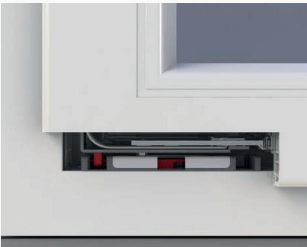
**03** Fenster ist geschlossen und verriegelt. Der 8-Kant-Verschlussbolzen hinterkrallt beim Verschließen das Sicherheitsschließblech und der Tresorbolzen verriegelt mit dem Fensterflügel. Ein Aushebelschutz von bis zu einer  $\frac{1}{2}$  Tonne gewährleistet höchste Sicherheit.
